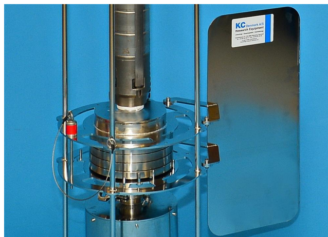
图 2 23.575 A 微塑料采样泵装有转向鳍，防止电缆在下水采样过程中扭曲缠绕。
